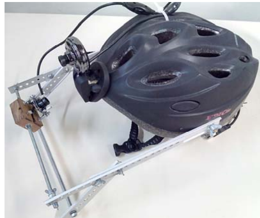
Figura 2: Rastreador do olhar montado num capacete de ciclista com uma câmera voltada para os olhos e outra para a cena.
